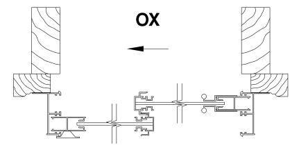
FIGURE 13: ADJUSTABLE BOTTOM ROLLERS
